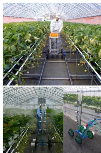
図3 試作した収穫台車(上)及び防除機(下)
